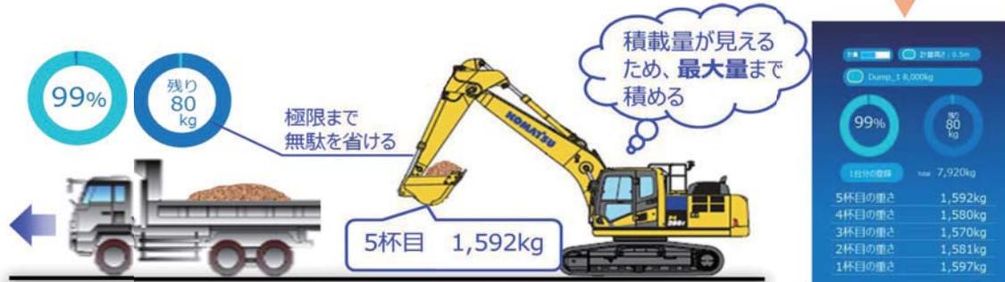
・ペイロードメータではリアルタイムに積載量が見える化されるので、経験に頼らず積載量を最適化することができます。
