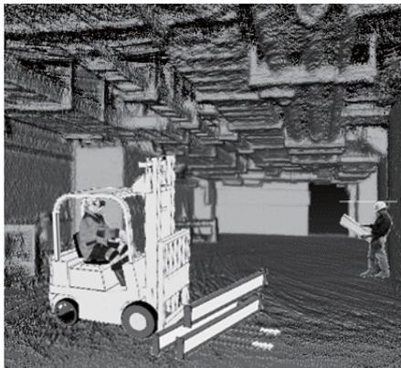
図-7 ウェアラブルカメラを装備したオペレータが AR 内で、マシンガイダンスを利用して移動
