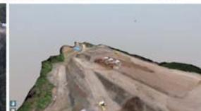
中間検査時点のUAV観測データに施工状況3Dモデルを配置
