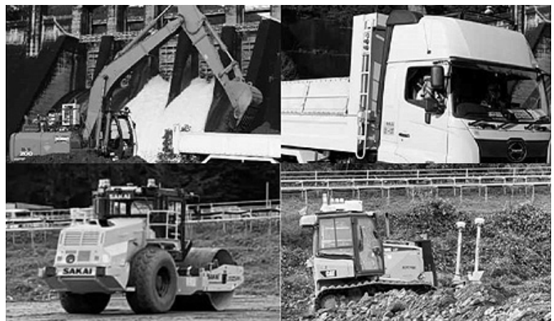
図-5 複数の重機の自動・自律運転の様子
