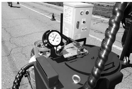
写真-3 アスファルト目地注入機（操作盤）
