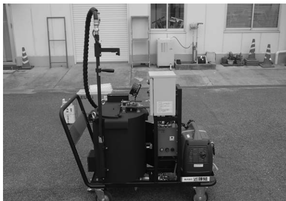
写真-2 アスファルト目地注入機
