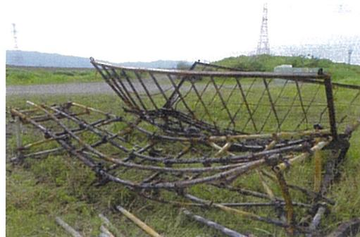
写真-5 : 焼却熱で曲がった焼却架台本体
