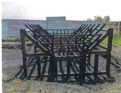
写真-4 : V型形状に改善した焼却架台
