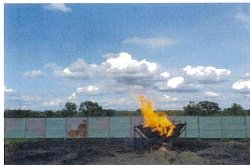
写真-6 : 圧縮空気を噴射した焼却状況
