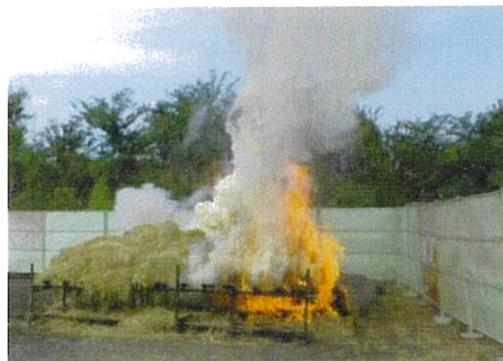
写真-3 : 圧縮空気を噴射しない燃焼
