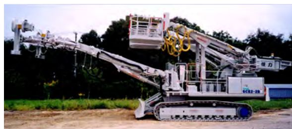
写真-1 支保工建込みエレクタ
