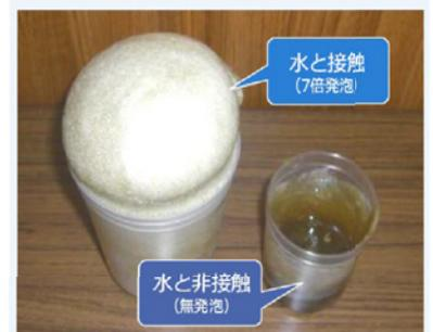
② 帯水層における湧水との反応により水脈を閉塞してトンネルへの引き込み水量を減少し、最終的に無発泡体の防水ゾーンを形成することにより、減水・止水する
