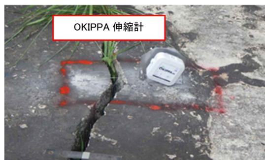
写真-7 クラックの計測事例
