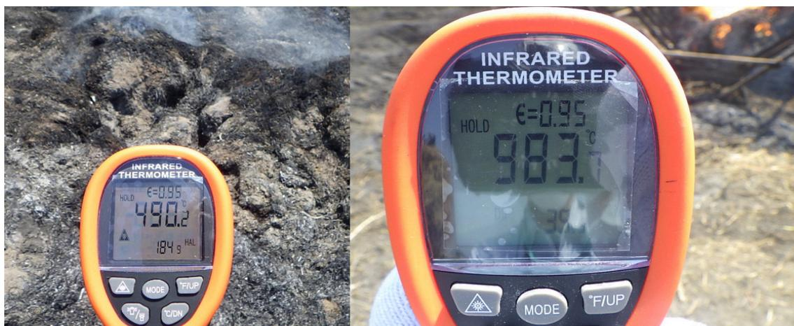
写真 7 焼却時の温度(左:地面焼却 右:「モヤッシー」による焼却)
