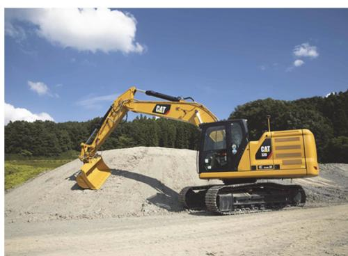
設計面どおりにマシンコントロール技術を用いて施工していくのが ICT 施工ですが、精度の高い施工を目指すには、まずは車体の水平が担保されている事が重要です。まずはこの『足場を作る作業』に時間をかけるのが当たり前ですが、この車体の傾きに影響されずに ICT 施工を進める事が出来るよう、チルトバケットのチルト角度を設計面にあわせて自動補正するのが『チルトアシスト』です。(写真 2)
