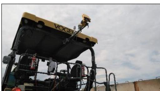
写真-4 Pave-IR アンテナ設置状況
