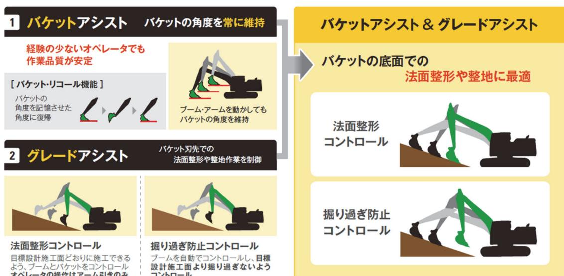
図 2 バケットアシスト/グレードアシスト
