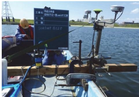
写真-4 MBによる測量状況
