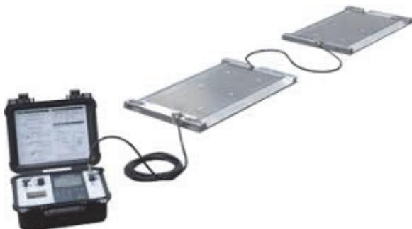
写真-3 携行型トラックスケールの例
