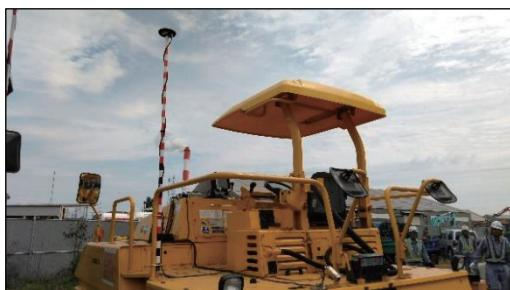
写真-6 GNSSアンテナ設置状況
