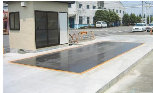
写真-2 定置式トラックスケールの例
