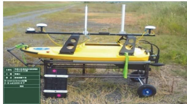
写真-5 MB測量船(自動航行タイプ)
