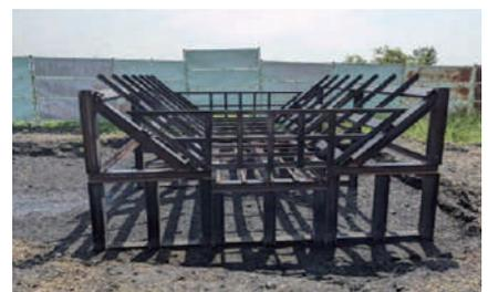
写真-3 V字形に改善した焼却架台
