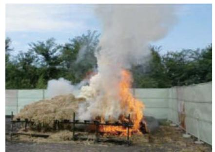
写真-2 平面格子状の焼却架台
