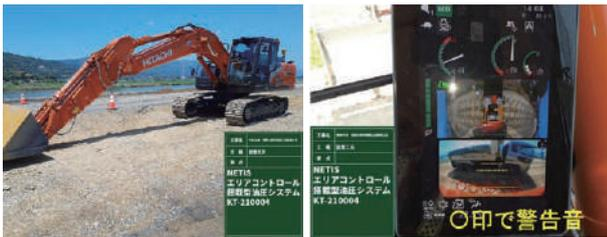
写真-7 エリアコントロールシステムバックホウ
