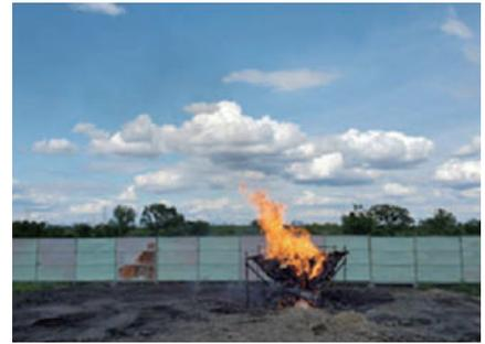
写真-4 圧縮空気を噴射した焼却状況
