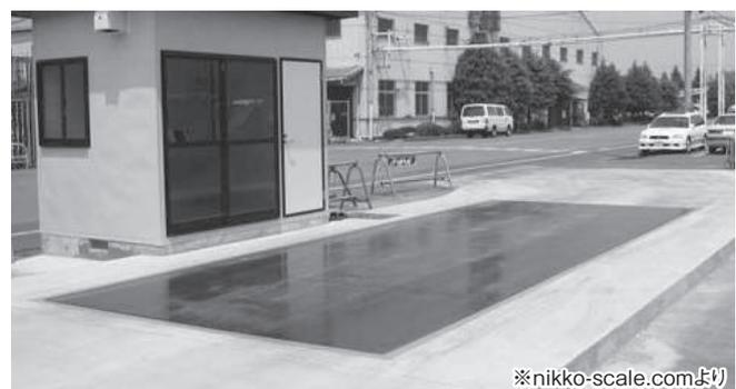
写真-2 定置式トラックスケールの例
