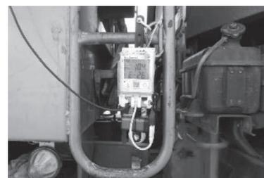
写真-1 温度ロガー設置状況
