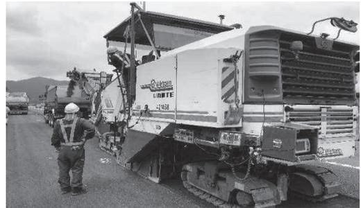
「3D-RTC工法」は、切削機の2次元位置をGNSSで計測、制御位置の施工厚を超音波等で計測し、設計施工厚と同じになるように切削機を3次元制御する工法です。
