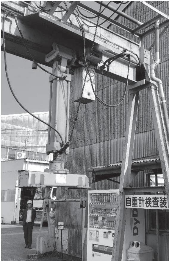
写真-6 自重計検査装置
