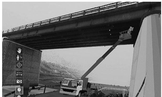
● 点群利用により、既設構造物のモデリング
