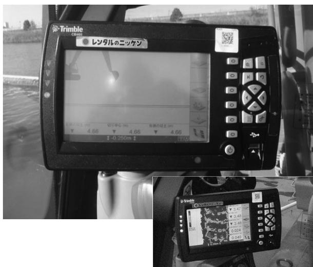
写真-3 バックホウの運転席のモニター画面
