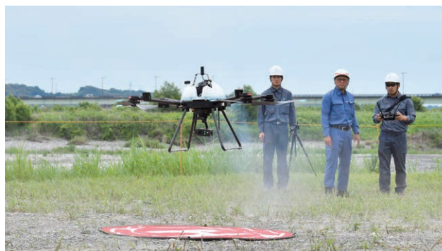
ハイブリッド・ドローンによる被災状況調査 (日本建設機械施工協会)
