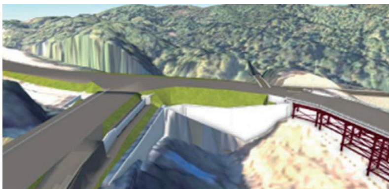
②統合CIMモデルの作成(左:付替道路、右:低水放流管)
